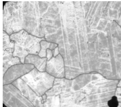
Figure VI-7. Cartographie de photocourant en lumière rouge ( \lambda > 750 nm) après deux étapes de « gettering » (diffusion P : 880°C - 1h + formation de l'alliage Al-Si: 880°C- 30 min).
