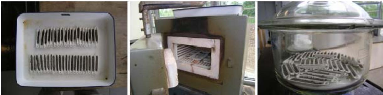
Figure 2.20 Photographies illustrant les différentes étapes des mesures de Perte Au Feu.
