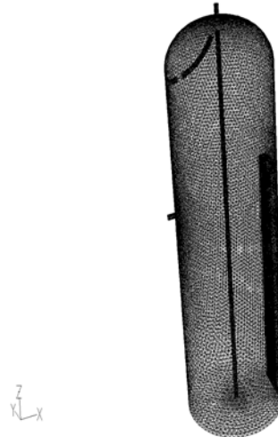
Figure 45 : Maillage du ballon solaire
