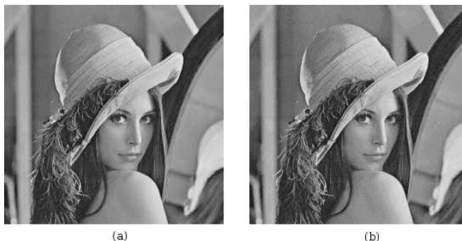
FIG. 3. L'image originale (a) et l'image reconstruite (b) sur 39 niveaux de gris pour un PSNR de 38,52 dB
