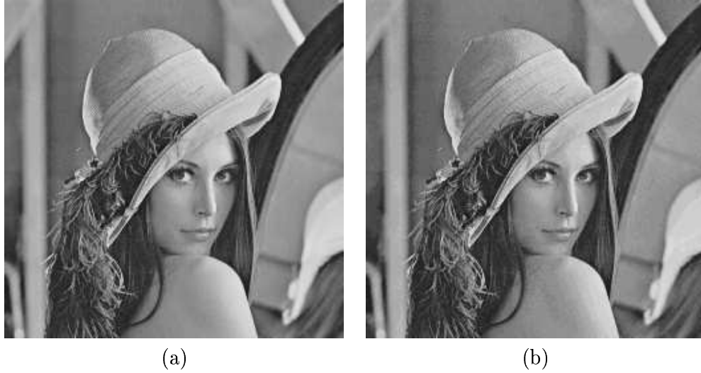
FIG. 5.7 – L'image Lena de base (a) et sa quantification sur la partition \hat{P} (figure 5.6(b)) à 39 intervalles. PSNR = 38,52 dB.
