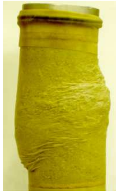
FIGURE 2.24 – Photographie de l'échantillon testé à l'essai triaxial pour S_f et pour S_c ( \phi = 70 mm).
