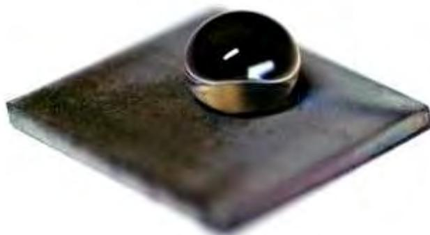
**Photo III.2 : Goutte d'eau sur une plaque d'acier recouverte d'oxyde de silicium,  $\theta = 150^\circ$**
