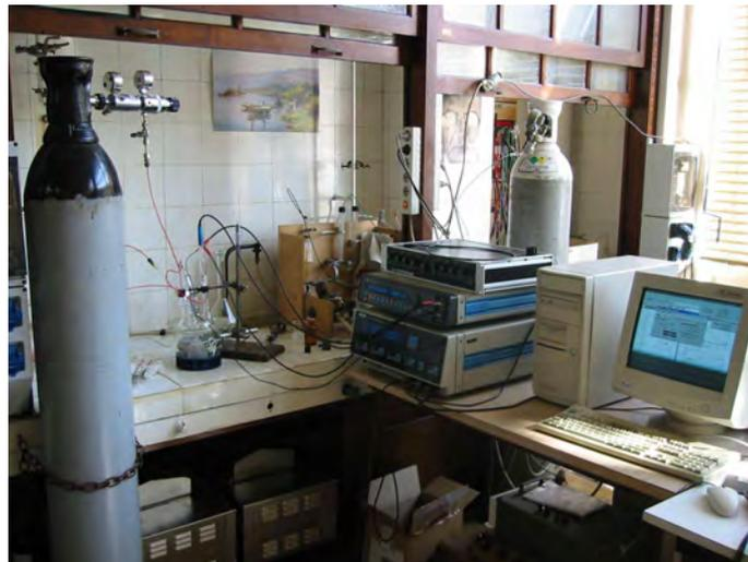
*Photo II.3 : Installation pour les mesures d'impédance*
