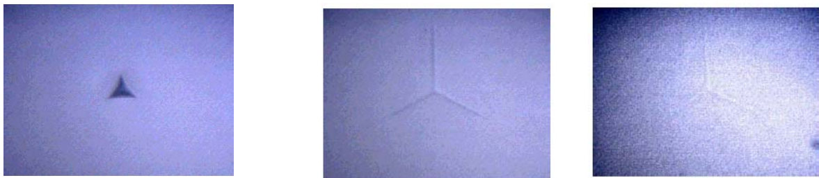
Figure 7. Photographie optique d’un substrat de PMMA (a), d’un film de SiZr1 d’épaisseur 15 \mu\text{m} (b) et d’un film de SiZr4 d’épaisseur 15 \mu\text{m} (c) après des tests de nanoindentation avec des charges de 15 mN, 450 mN et 450 mN respectivement.
