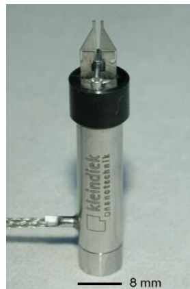
FIG. 1.39 – Micropince “Omega Gripper” de la société Kleindiek Nanotechnik (Allemagne)
