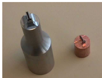
FIG. 4.5 – Sonotrode permettant la réalisation d'un actionneur en "T"
