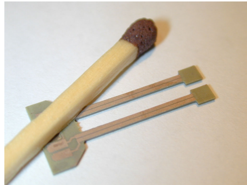
FIG. 4.3 – Micropince à quatre degrés de liberté (2 duo-bimorphes) usinée par ultrasons.
