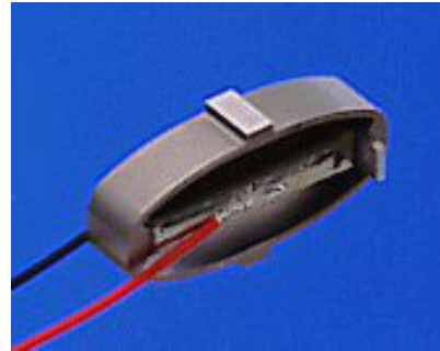
FIG. 2.11 – Actionneur elliptique amplifié (source Cedrat Recherche).
