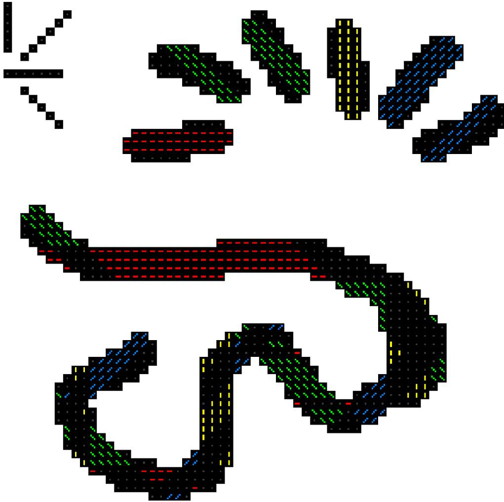
FIG. 3.21 – Champ d'orientations locales obtenu par la méthode de Soillé et Talbot (1998).
