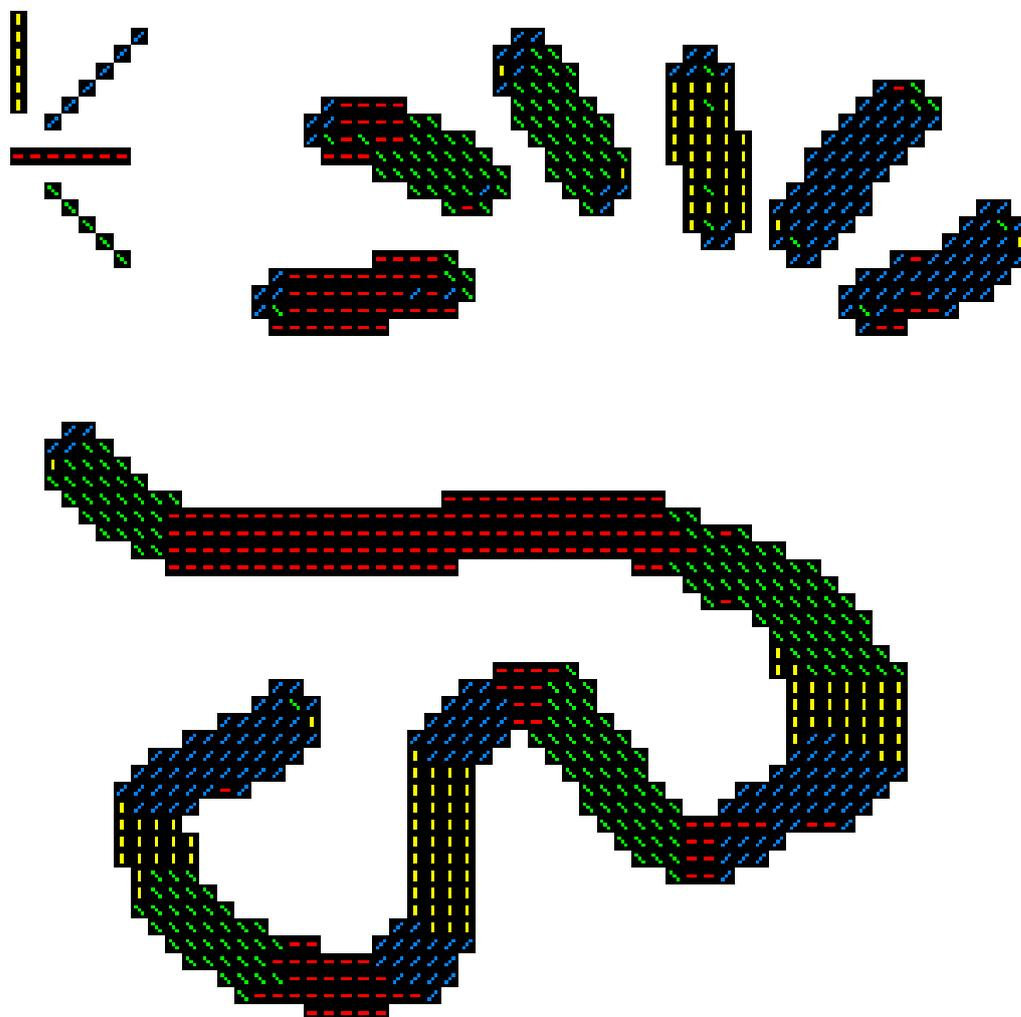
FIG. 3.23 – Champ d'orientations locales obtenu par érosions.
