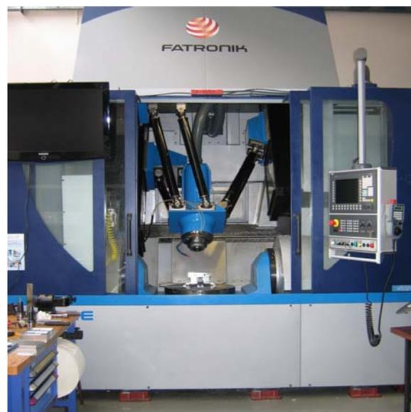
Fig. 54 : Machine parallèle Verne et Siemens 840D à l'IRCCYN
