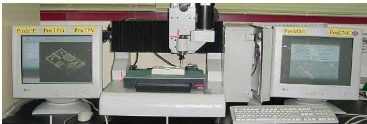
**Fig. 34 : Prototype coréen de chaîne numérique Step\_NC**
