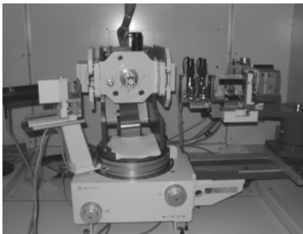
Figure A.7 : Photographie et schéma du dispositif de diffraction X haute résolution (Seifert XRD 3003 PTS).
