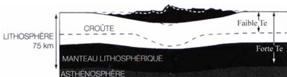
Figure b.I.7. Schéma illustrant la flexure de la lithosphère en fonction de son épaisseur élastique ( T_e ).
