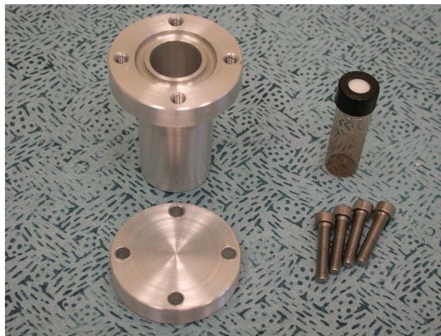
Figure IV-9 Photo de la jaquette de protection en aluminium et du flacon en verre de 4 mL fermé par un bouchon à vis et un septum, utilisés lors de l'irradiation.
