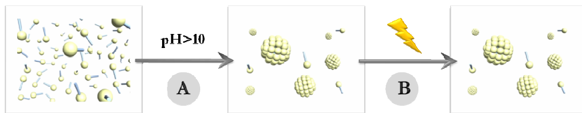
Figure III-15 – (A) Formation des micelles à \text{pH} > 10 ; (B) Polymérisation des micelles par irradiation lumineuse à 254 nm
