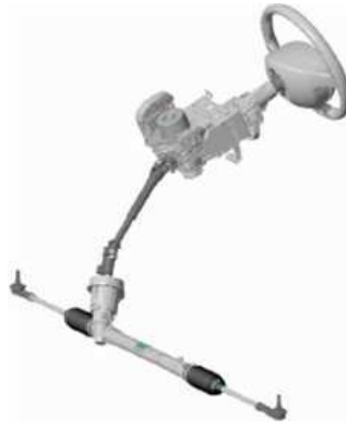
FIG. 2.4 – Colonne de direction à moteur d'assistance électrique, développée par TRW .
