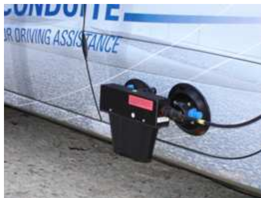
FIG. 4.34 – Système de mesure de l'angle de dérive du vecteur vitesse CORREVIT.
