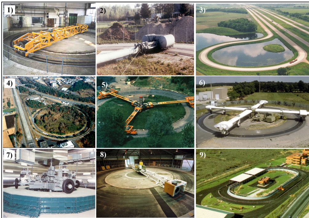
Figure 1.24 – Simulateurs de trafic lourd circulaires. 1) Roumanie 2) Suisse 3) E.U. – Minnesota 4) Japon 5) Slovaquie 6) France 7) Japon 8) Nouvelle Zélande 9) Espagne [AFD40, 2004]
