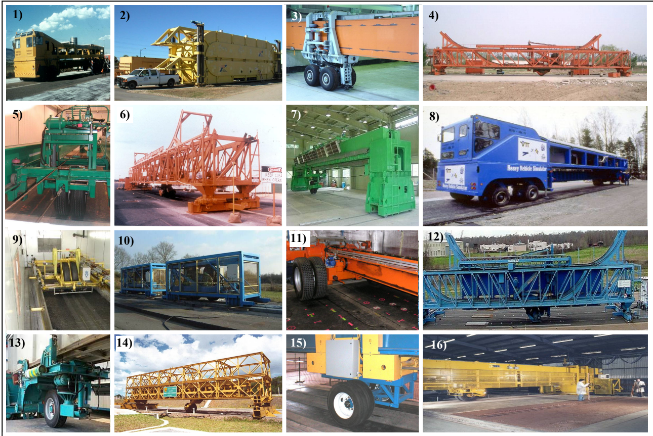
Figure 1.23 – Simulateurs de trafic lourd linéaires. 1) Afrique du Sud 2) E.U. – Texas 3) Japon 4) Chine 5) E.U. – Ohio 6) Australie 7) Corée du Sud 8) Norvège 9) Danemark 10) France 11) Suisse 12) E.U. – Louisiane 13) Pays-Bas 14) Brésil 15) E.U. – Kansas 16) Grande Bretagne [AFD40, 2004]
