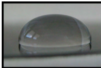
Fig. 3.2 – Photographie d'une gouttelette d'eau sur une surface de silicium silanisée par l'OTS. L'angle de contact de l'eau avec la surface est proche de 110°.
