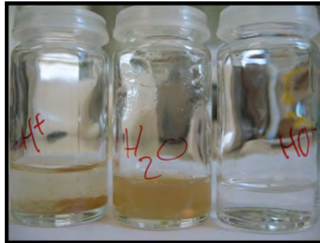
Fig. 4.5 – Influence du pH sur la dispersion des nanocristaux de silicium dans l'eau. Les photographies sont prises 3 heures après la préparation des dispersions. Au centre, à un pH \approx 7 , la suspension semble stable. A gauche, à un pH \approx 1 , les particules s'agrègent. A droite, à un pH \approx 12 , la solution est incolore, les particules ont été entièrement hydrolysées en quelques heures.
