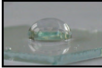
Fig. 3.5 – Photographie d'une gouttelette d'eau sur une surface de verre silanisée par l'OTS. L'angle de contact de l'eau avec la surface est proche de 110^\circ .
