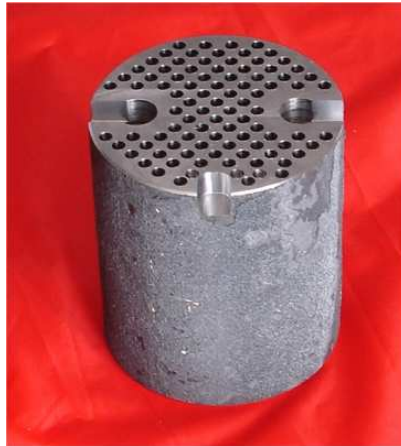
Figure III.3: Présentation d'une éprouvette de 35MnV7 de 100 mm de hauteur.
