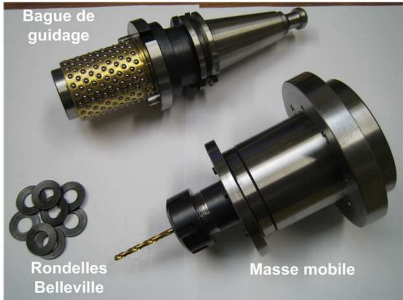
Les trois composants principaux de la tête de perçage
