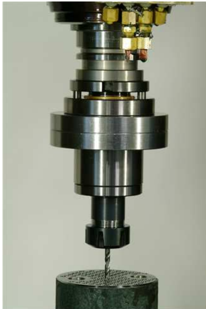
La tête de perçage positionnée dans la broche de la machine outil
