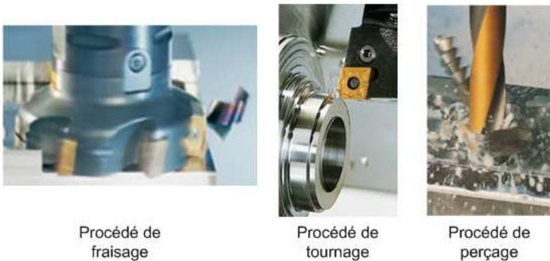
Figure I.1: Formation et évacuation du copeau pour les principales technologies de coupe [Sandvik, 1997].
