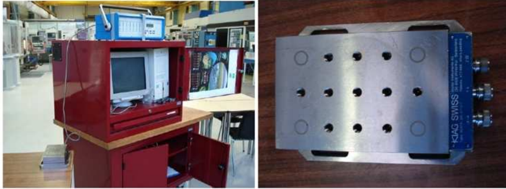
Figure III.7: La chaîne d'acquisition d'effort de coupe.
