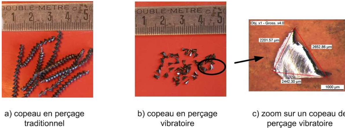
Figure I.20: Comparaison de la taille des copeaux entre perçage traditionnel et perçage vibratoire.
