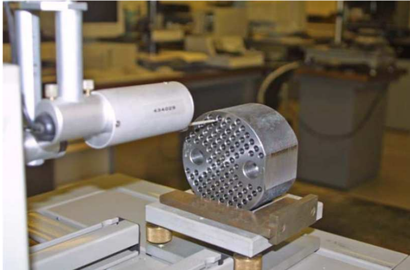
Figure IV.6: Mesure de rugosité avec le rugosimètre équipé d'un palpeur spécial "mesures profondes"
