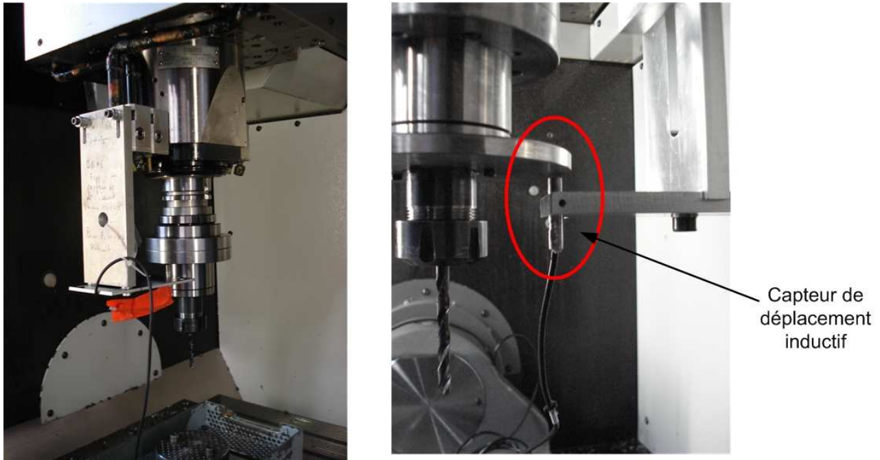
Figure III.10: Positionnement du capteur de déplacement inductif.
