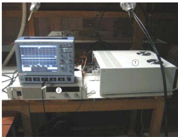
Figure 3.1 Photographie de l'alimentation impulsionnelle et de l'oscilloscope 1) générateur d'impulsion, 2) alimentation DC
