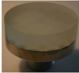
Fig. 16 Outillage verre basé sur l'utilisation d'une lentille pour le rodage.
