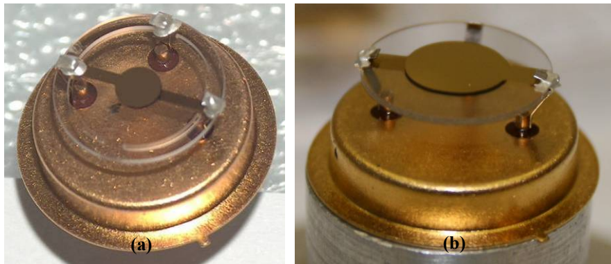
Fig. 27 Résonateurs avec découpes de ponts et résonateur sans pont.
