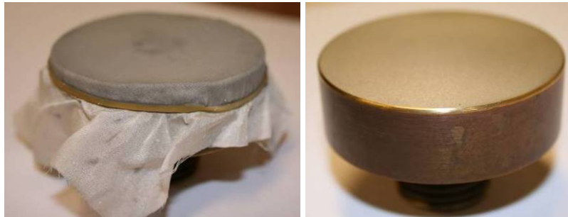
Fig. 17 Outillage laiton pour le rodage (à droite) et recouvert de soie pour le polissage (à gauche).
