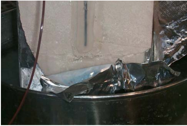
Figure 95. Formation d'une couche de glace, au cours du gel, sur les parois extérieures du cube de Pierre de Lens.
