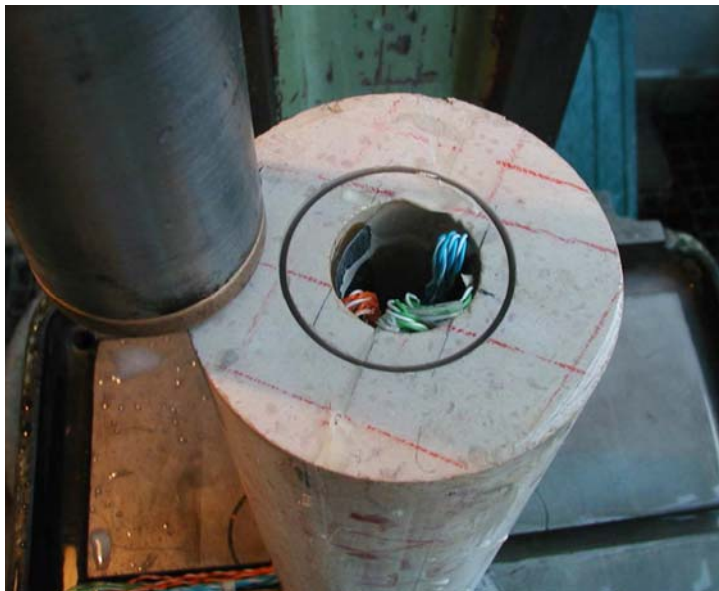
Figure 68. Surcarottage du tube de calcaire.
