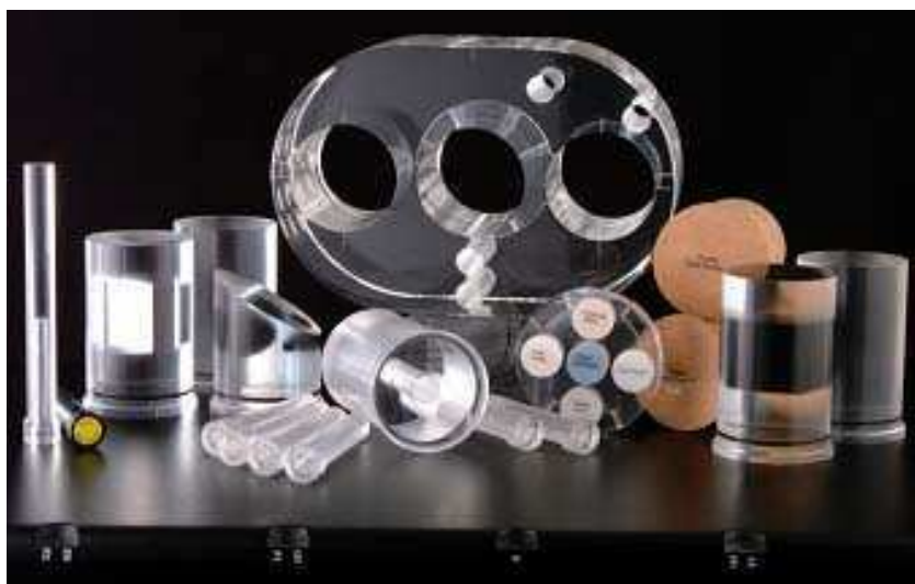
Figure 2.2 – Photographie de l'objet-test physique développé par Craig, le Quasar Multi Purpose Body Phantom [Modus].
