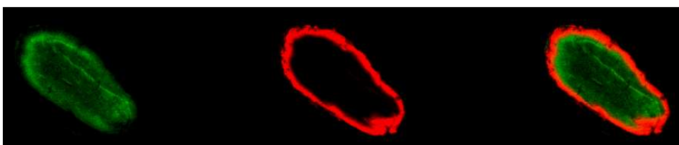
FIGURE 4.33 – Fissure créée dans une direction transverse de l’axe d’une travée de l’échantillon Z par la fatigue en compression.
