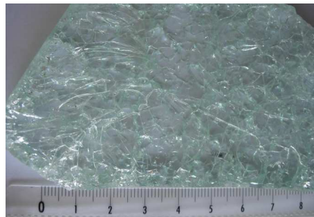
FIGURE 3.46 – Photo de la plaque de Pyrex fissurée utilisée pour les expériences.
