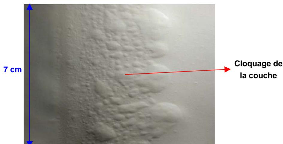
Figure 4. 17 : Cloquage de la couche au démarrage de la bobine lors d'un essai à une température du rouleau métallique de 260°C
