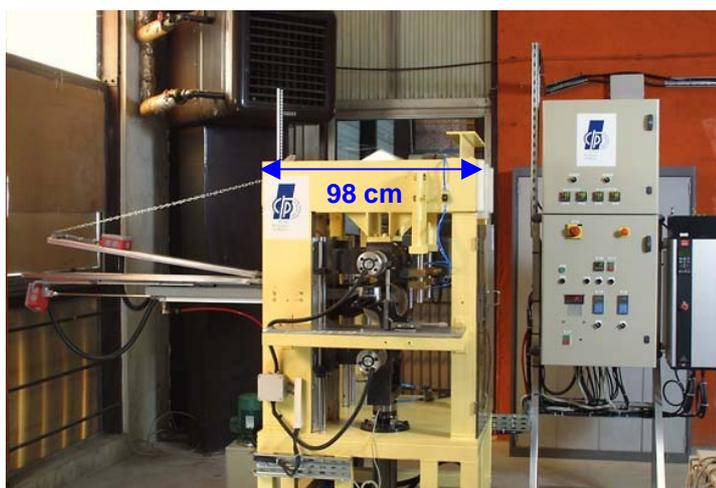
Figure 3. 1 : Vue générale de la calandre pilote avec l'insertion de feuille
