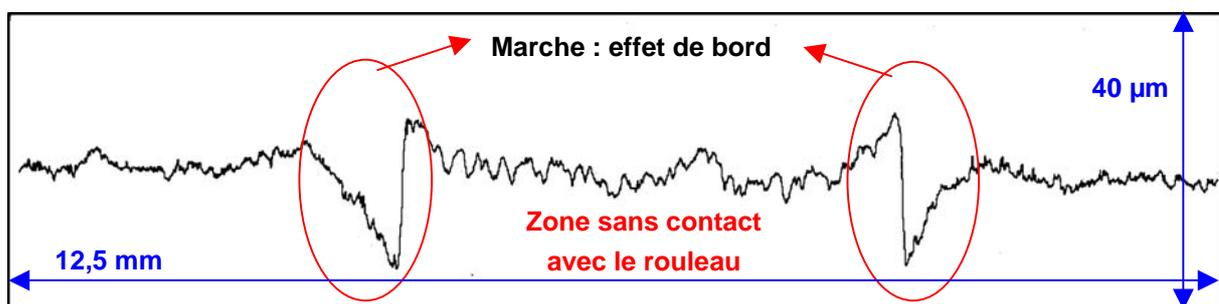
Figure 3. 40 : Profil de rugosité sur le papier F dans la zone de quadrillage (Perthometer) – Condition de calandrage : cf Figure 3. 39
