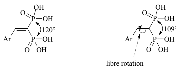
Schéma 162 : Différences structurales entre produit saturé et insaturé
