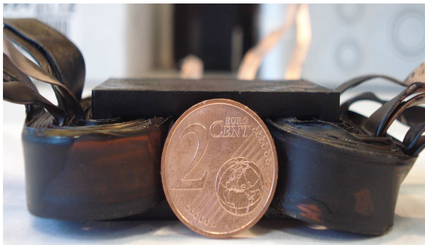
Fig. 15 : Composant intégré de type planar fabriqué par Microspire .
