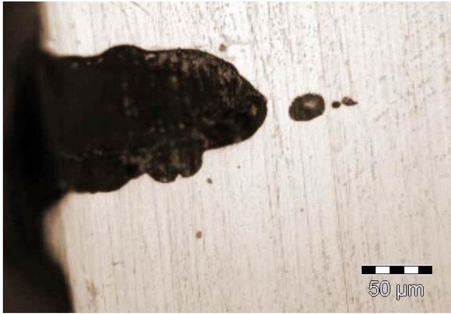
Figure II-34 : Coupe d'une piqûre après 10 mois d'immersion dans NaCl 0.5 M, à pH=7, naturellement aérée à potentiel libre : la propagation de la piqûre suit les particules intermétalliques. Au fond de la piqûre, les dernières cavités formées par la dissolution anodique des particules sont visibles.
