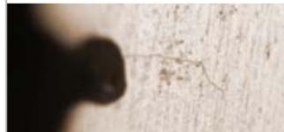
**4 - Développement des piqûtes et de la corrosion intragranulaire :**
