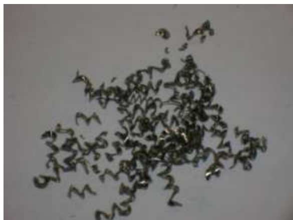
Figure E.5: Copeau obtenus durant l'essai de qualification.
