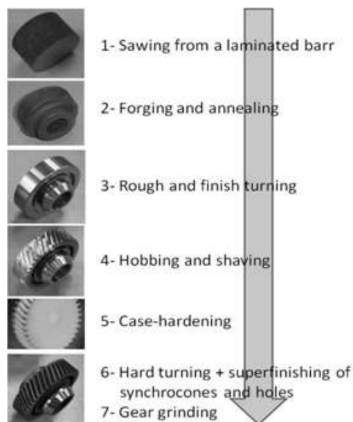
Figure 1.6 : Etapes de fabrication d'un cône de synchronisateur.
