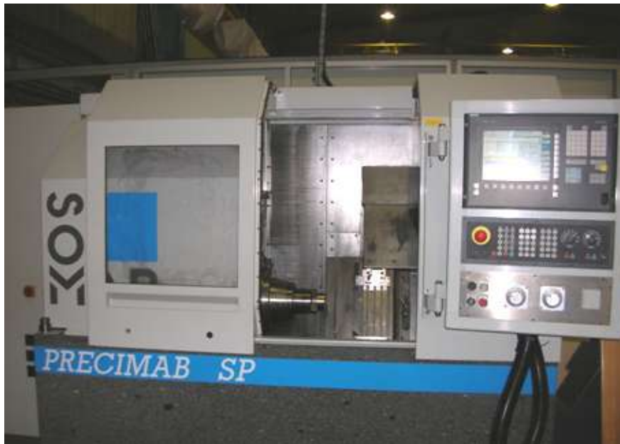
Figure E.1 : Tour utilisé pour les essais du C.O.M.
