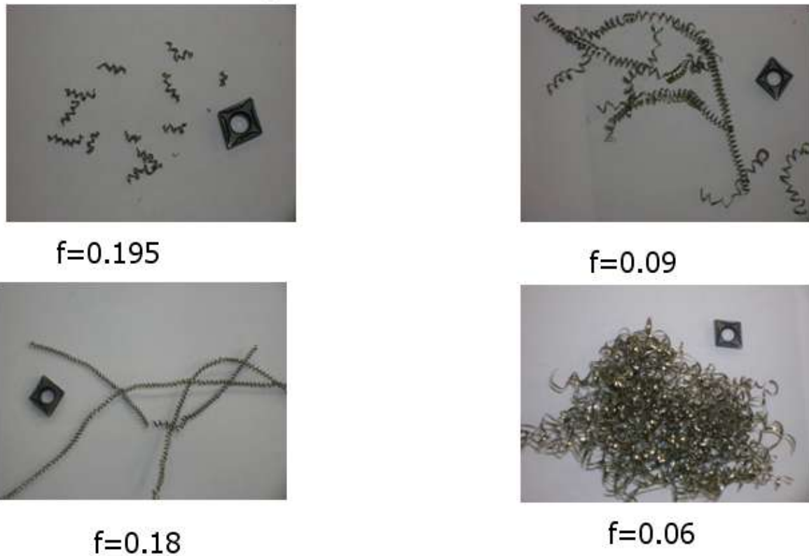
Figure E.11: Copeau obtenus durant l'essai de f min.
