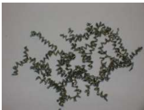
Figure E.8: Copeau obtenu durant l'essai V_c min.
