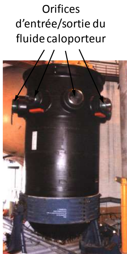
Figure 1.1 : Cuve de réacteur (Hauteur 13,66 m, diamètre 4,95 m, diamètre des tuyaux de sortie environ 800 mm) [SFEN].
