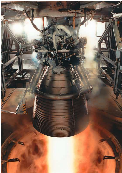
FIG. 4 – Moteur cryotechnique Vulcain 2 au banc d’essai ; image tirée de [72].
