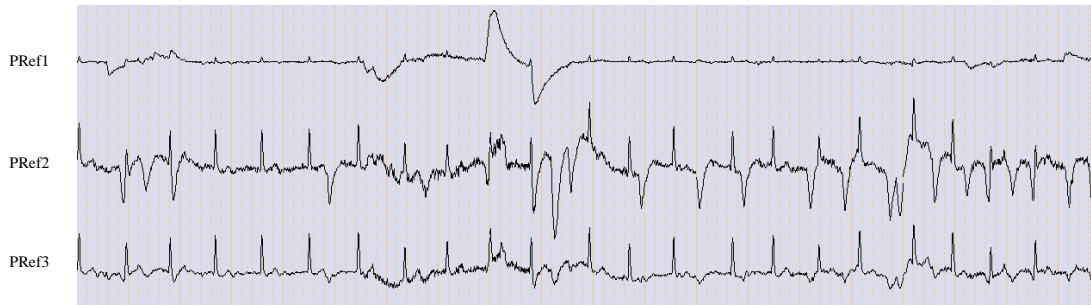
FIG. 2.23 – Les signaux pseudo-références générés pour la mise en correspondance entre les sources estimées par l'algorithme SAS/ACI et les activités électrophysiologiques recherchées : PRef1 pour \widehat{EOG2} , PRef2 pour \widehat{EOG1} et PRef3 pour \widehat{ECG} .
