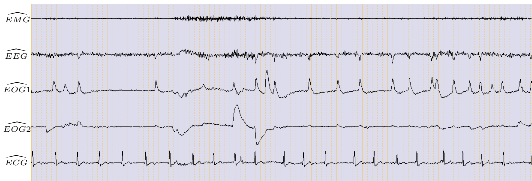
FIG. 2.41 – Résultats obtenus après application de nos quatre étapes sur les signaux représentés en figure 2.21 (b). L' \widehat{EMG} est obtenu par filtrage passe-haut. L' \widehat{EEG} , l' \widehat{EOG1} , l' \widehat{EOG2} et l' \widehat{ECG} sont obtenus par une ACI suivi de l'étape de mise en correspondance.
