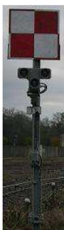
(a) Signal mécanique fermé, « carré »
