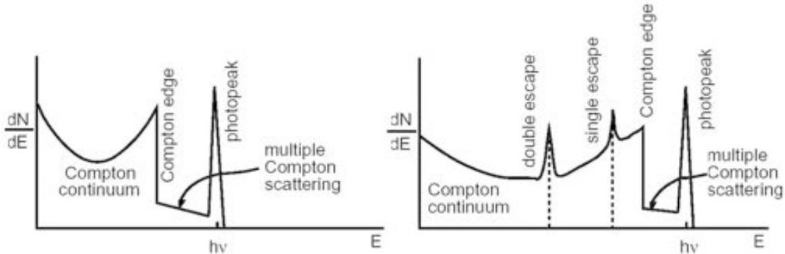
FIG. 3.3 – Réponse spectrale d'un détecteur gamma. A gauche pour les photons incidents d'énergie inférieure à 1022 keV. A droite pour les photons incidents d'énergie supérieure à 1022 keV.
