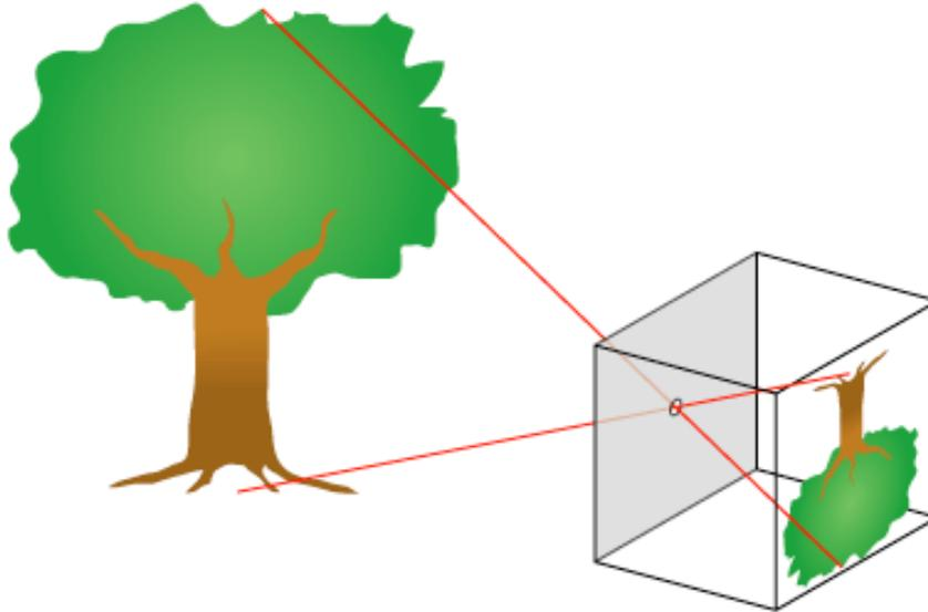
FIG. 3.7 – Principe de la *camera obscura*.
