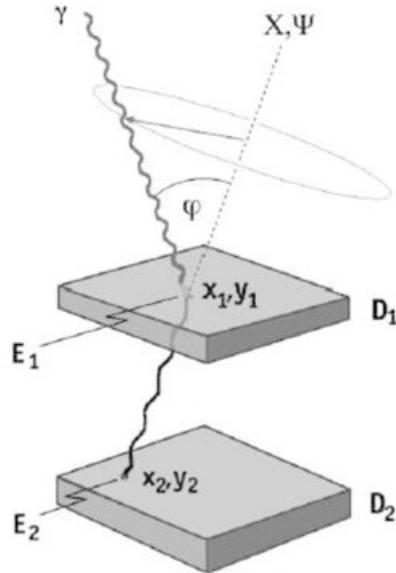
FIG. 3.5 – Principe de fonctionnement d'un télescope Compton.
