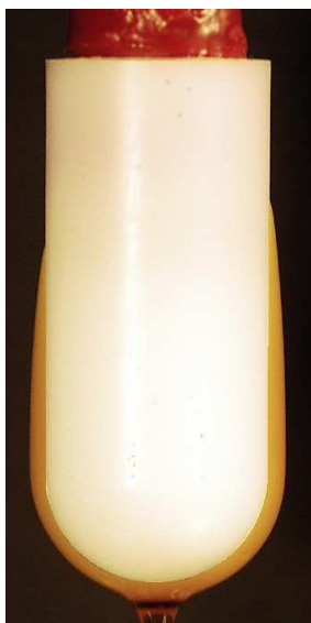
a/ Photographie du trempage dans le cas du miel avec montage pour superposer le moule
