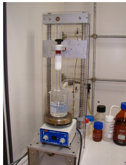
Figure 3-20 : Photo de la machine de trempage
