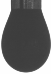
Figure 3-17 : Photographie d'une goutte pendante de PVA permettant de mesurer la tension de surface liquide / air
