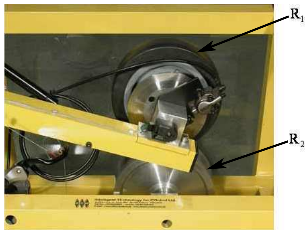
FIG. V.12 – Vue sur les deux roues du système ABS
