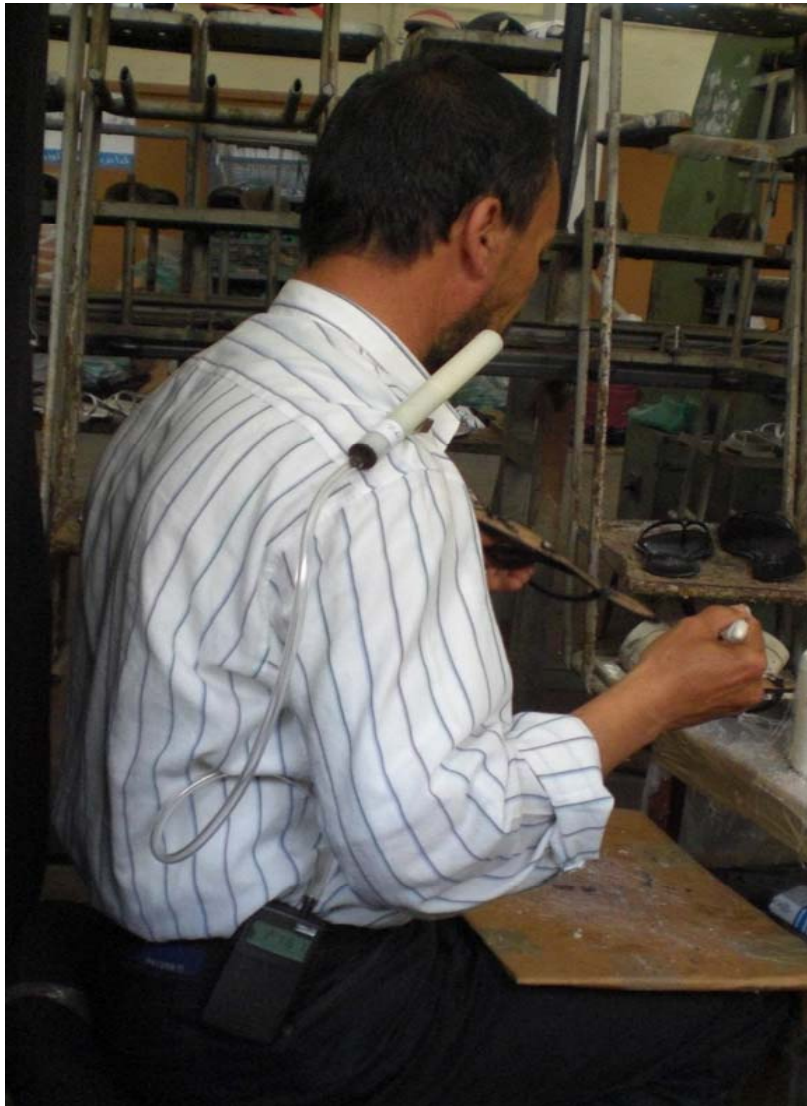
Figure 5.a. Prélèvement l'atmosphère « individuel »
