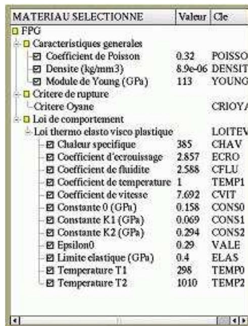
FIG. 6.4 – Exemple d'une mise en données des paramètres matériau.
