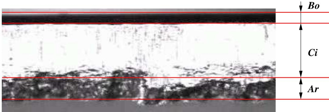
FIG. 6.12 – Profil géométrique de l'alliage cuivreux CuNiP d'épaisseur 0.2 mm (grossissement x200).
