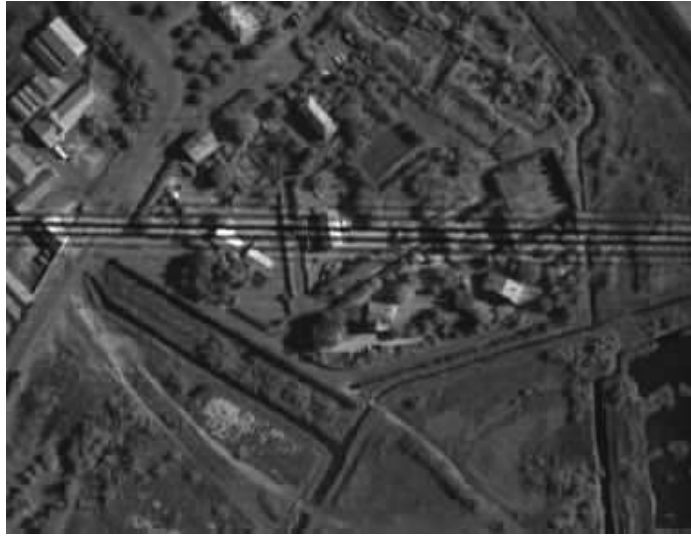
FIG. 4.2 – Exemple d'image que nous avons obtenue à l'aide d'un spectro-imageur par transformée de Fourier statique à grande étendue : la superposition des images de la scène et des franges apparaît très clairement.
