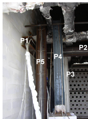
(d) Positions des poteaux et poutres pour les essais 3 à 5. Le poteau P6 est au centre du four.
