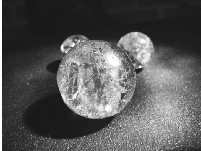
FIG. I.4 : Fragmentation d'une bille après un choc thermique
