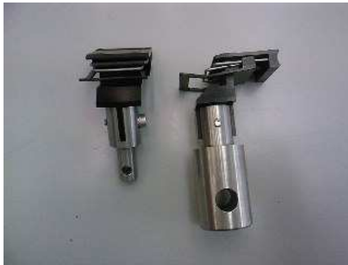
Figure II- 1 Photographie des mors adaptés à la caractérisation de films minces
