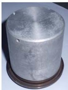
*Figure 70 : Gabarit pour la mise en place de l'enroulement du thermocoax entre l'enveloppe thermostatée et la cellule de craquage thermique.*
