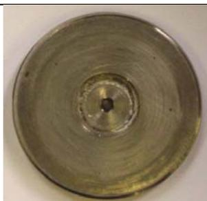
Figure 68 : Dépôt visible de poudre de  $Y(tmhd)_3$  dans la gorge intérieure du couvercle de la cellule d'effusion montrant une mauvaise étanchéité de la cellule.
