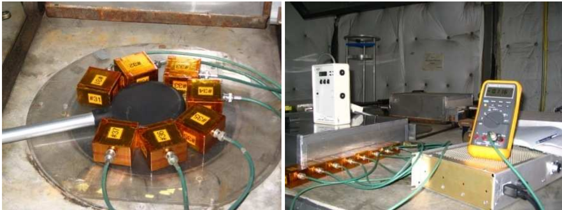
FIG. 4.22 – Photographies de la calibration des détecteurs au CsI.
