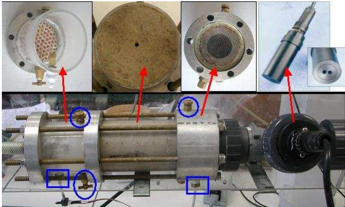
Figure 4-2 : Cellule d'essai avec le turbidimètre Symboles rectangulaires : capteurs de pression, symboles ronds : valves de purge d'air, symbole elliptique : valve d'évacuation d'eau
