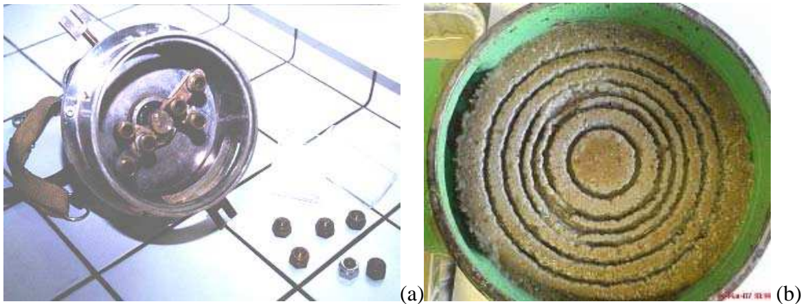
Figure 3.2 : a) Érodeur retourné, montrant sa chambre de pluie dans laquelle tournent les bras portant les gicleurs, b) les sillons d'érosion d'un échantillon
