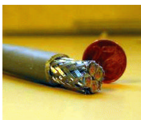
Figure III.7 – Câble blindé à 4 fils utilisé dans cette étude
