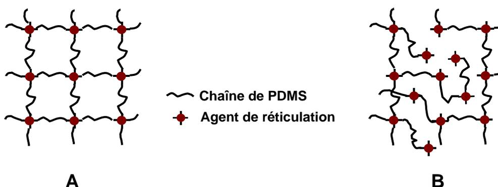
**Figure V.17 :** Représentation schématique d'un réseau parfait (A) théoriquement peut être obtenue à partir d'un rapport base/agent de réticulation de 10/1 en masse. (B) Réseau obtenue en augmentant la quantité de l'agent de réticulation. Nous avons plutôt des longues chaînes et probablement plus de chaînes pendantes.
