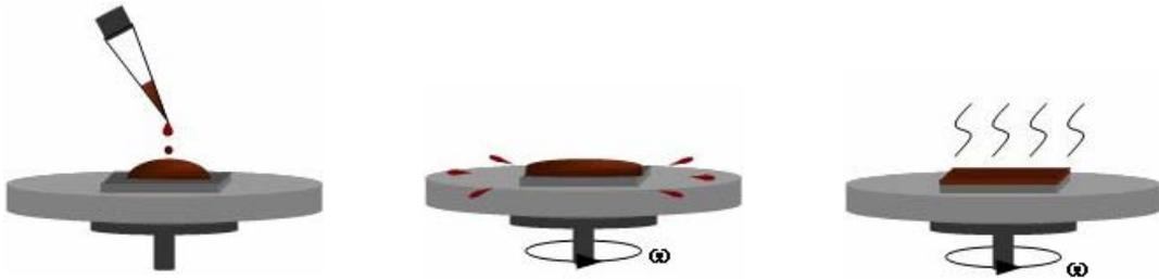
**Figure II.9 :** *Dépôt d'un film mince à l'aide d'une tournette (spinner)*
