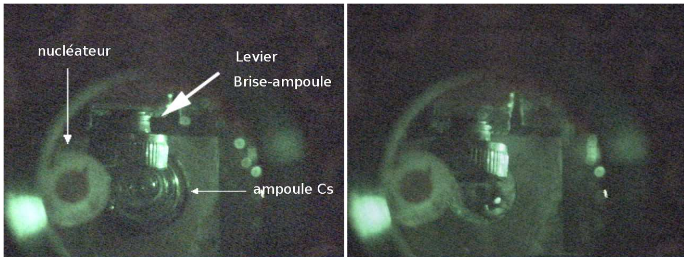
FIG. 2.28 – Fonctionnement du brise ampoule (Vue de dessous de la cellule). À gauche la situation initiale, avec l'ampoule au centre. À droite, après l'introduction de 10 bar dans le soufflet, son avancée a cassé la partie inférieure de l'ampoule. Il ne reste que la partie supérieure avec la surface du césium en vue directe.
