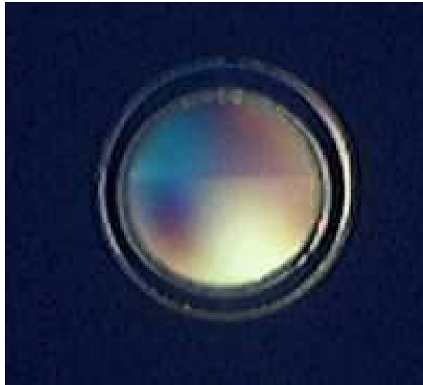
FIG. 2.32 – Un cristal d'hélium solide remplit tout le bas de la cellule optique. Le cristal est photographié entre 2 polariseurs HN38 croisés. On peut voir un contraste entre la phase solide plus dense et biréfringente en bas et la phase superfluide isotrope au dessus.
