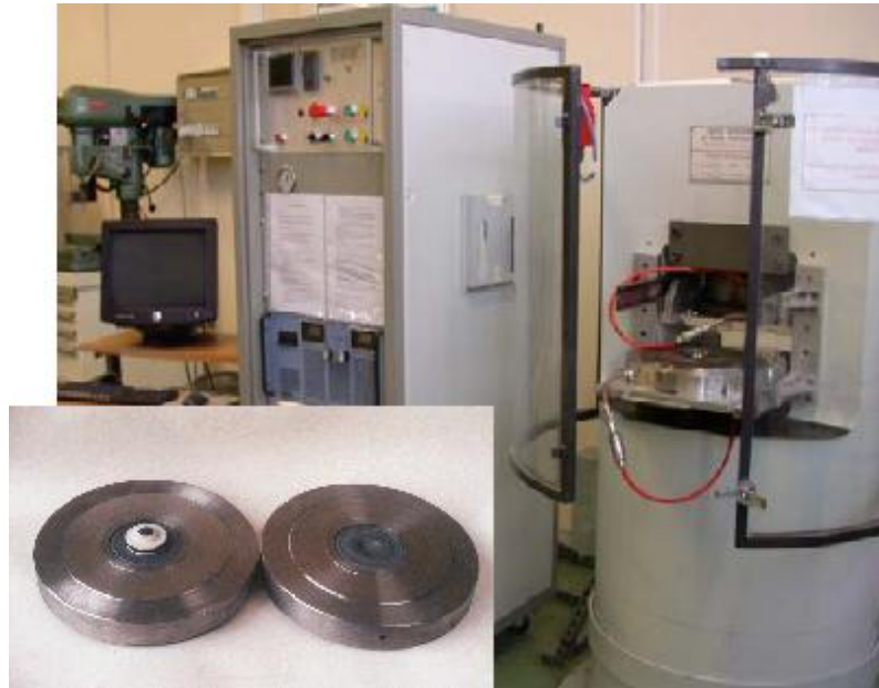
FIG. B.3: Photo de l'ensemble presse 1000 tonnes avec système CONAC (à droite) et armoire de régulation électronique (au centre). En encart à gauche, une photo de l'enceinte de type CONAC avec joint de calcite constituant la cellule haute pression placé sur une enclume.
