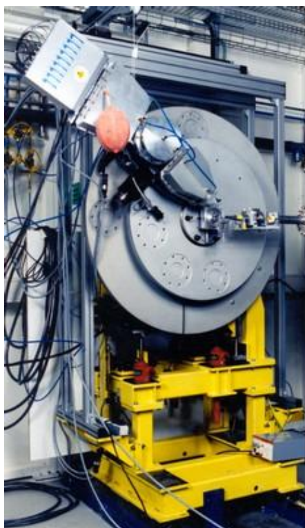
FIG. A.4: Photo de la géométrie 2\theta de la ligne ID31 (à gauche). Schéma du système d'analyse et de détection à neuf détecteurs (à droite).
