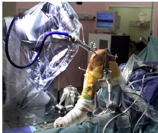
FIG. 1 – Fraisage du tunnel tibial effectué par le robot Caspar ® lors d'une ligamentoplastie du LCA. (Photo : J.P. Perrier)
