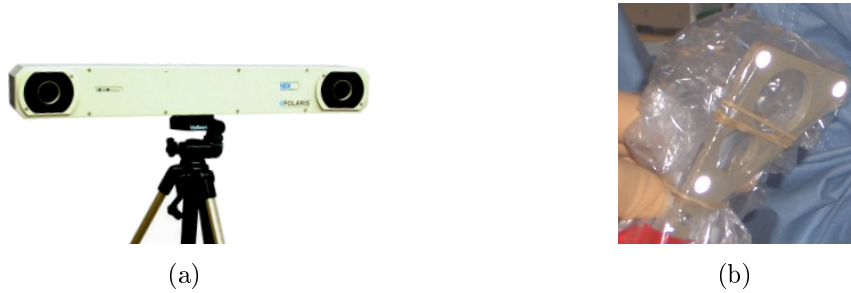
FIG. 2.4 – (a) Localisateur Polaris ® monté sur un trépied. (b) Corps rigide formé de trois marqueurs rétro-réfléchissants, isolé dans une housse stérile.
