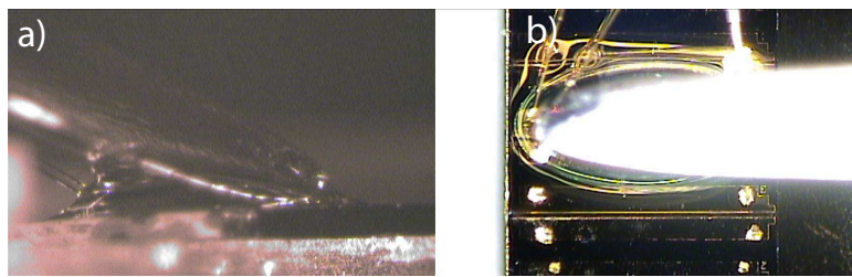
FIG. 6.6 – a) Goutte stable d'IPA vue avec la caméra 1. b) Goutte stable d'IPA vue avec la caméra 2.
